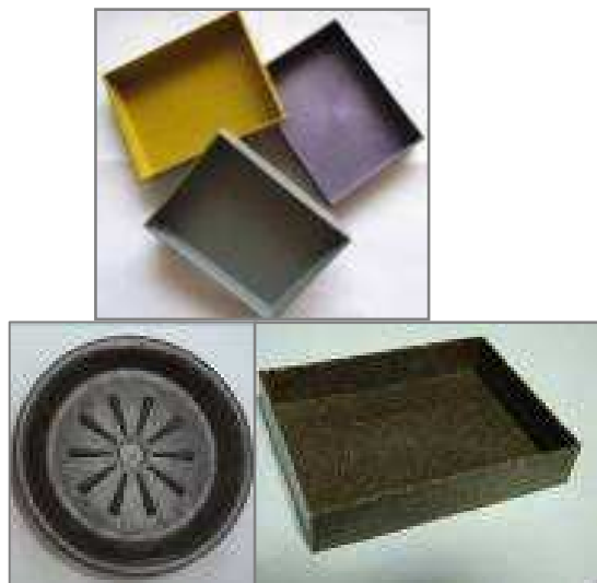
รูปที่ 10 วัสดุผสมเส้นใยหญ้าแฝกและพอลิพรอพิลีน
