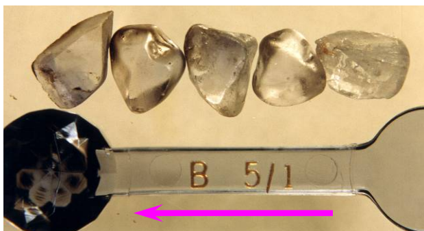
รูปที่ 5 ไพลินสีอ่อน (light blue sapphire) หลังไนโตรเจนไอออนอิมพลานเตชันที่โดสค่าต่าง ๆ มีสีใสเพิ่มมากขึ้นตามค่าโดสที่เพิ่มขึ้น (ลูกครี) เมื่อเปรียบเทียบกับไม่ได้ไอออนอิมพลานเตชัน (เม็ดขาวสุด)
