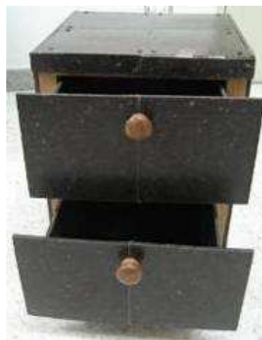
รูปที่ 12 ตู้เก็บของจากวัสดุผสมเส้นใยผักตบชวาและพอลิพรอพิลีน
