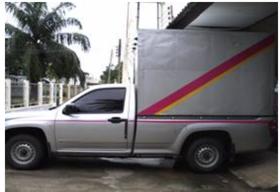
รูปที่ 6 การดัดแปลงรถเพื่อนำมาใช้ในการขนส่งมูลฝอยติดเชื้อ
