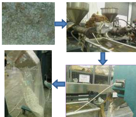
รูปที่ 2 ขั้นตอนการทำเม็ดคอมพาวด์
