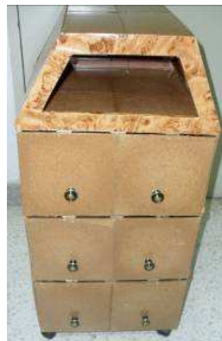
รูปที่ 11 ชั้นวางรองเท้าจากวัสดุผสมเส้นใยชานอ้อยและพอลิเอทิลีน
